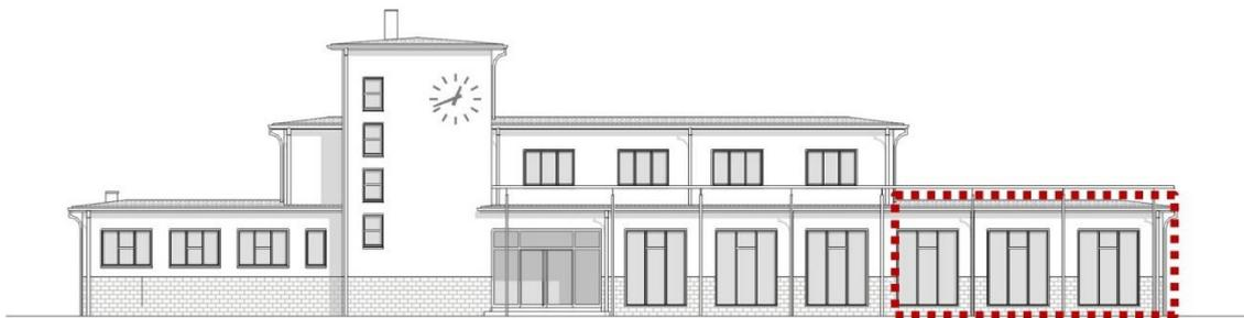
Abb. 13 Teilrückbau des Aufnahmegebäudes, Nordfassade
