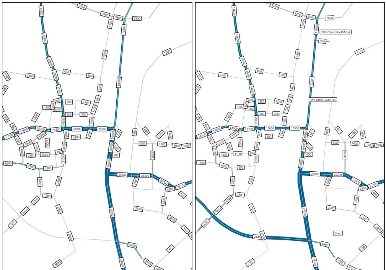
Abbildung 6: Belastungspläne Strassennetz regionales Verkehrsmodell, Zustände 2010 und 2020
