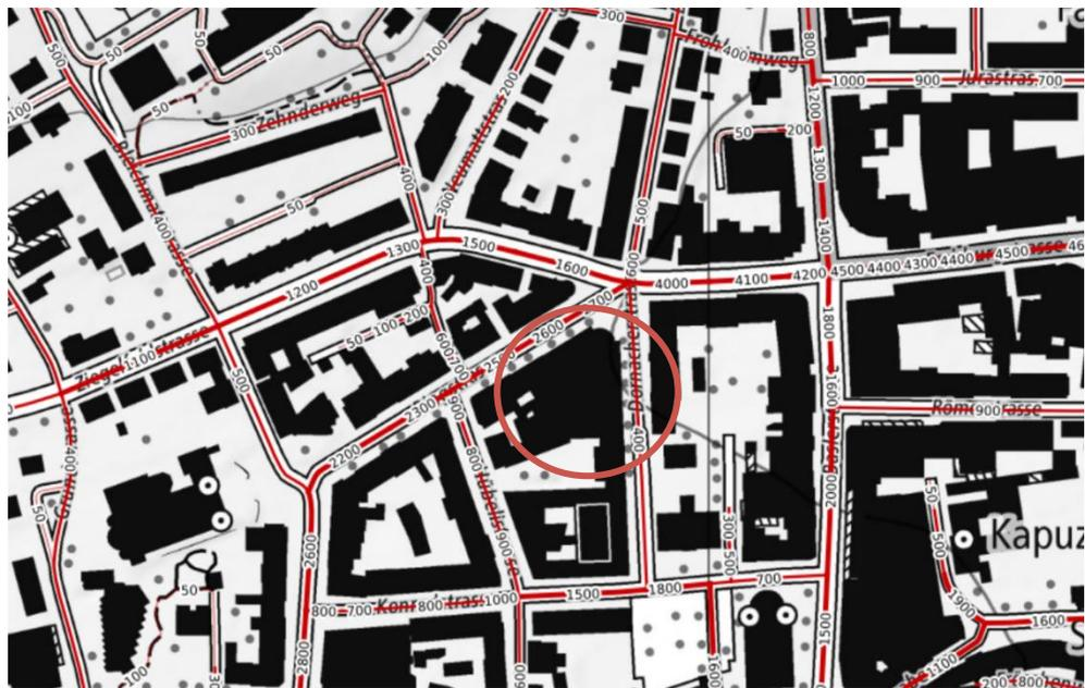
Abbildung 17: Verkehrsmengen Fussverkehr (Quelle: Forschungsprojekt SVI 2019/007 Methoden zur analytischen Ermittlung von streckenbezogenen Fussverkehrsmengen)
