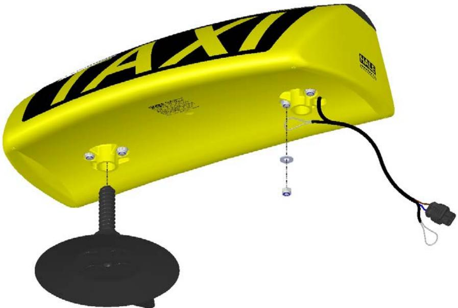
Nachdem der Boden abgenommen wurde kann die LED-Leiterplatte getauscht werden. Bei der LED-Leiterplatte handelt es sich um ein Original HALE-Ersatzteil.
