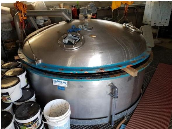
Abbildung 4: Kieselgur-Druckanschwemmfilter
