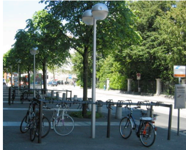
Abb. 16: Ungünstiger Ständertyp, fehlende Überdachung, fraglicher Standort von Abstellanlagen reduzieren die Attraktivität einer Veloinfrastruktur.
