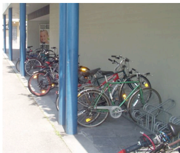
Abb. 16: Ungünstiger Ständertyp, fehlende Überdachung, fraglicher Standort von Abstellanlagen reduzieren die Attraktivität einer Veloinfrastruktur.
