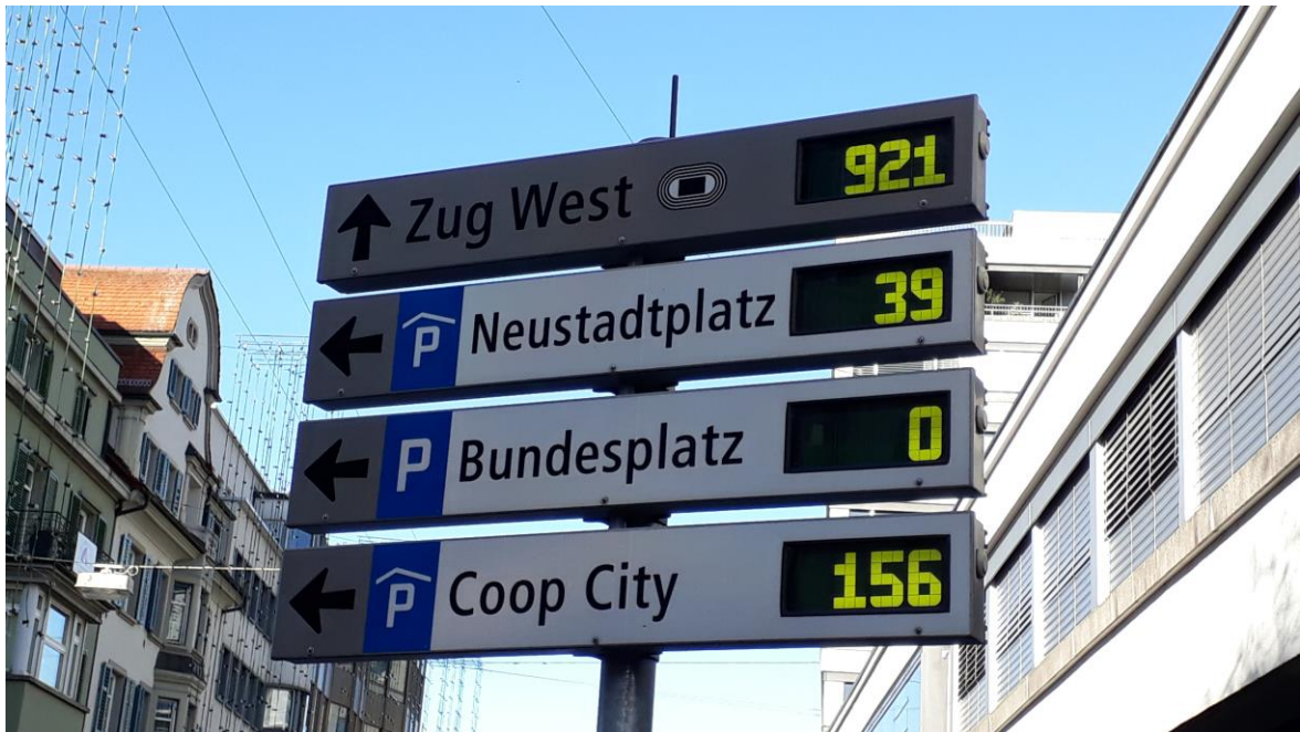
Abbildung: Beispiel eines PLS-Schildes mit LCD-Technik (PLS Zug)
